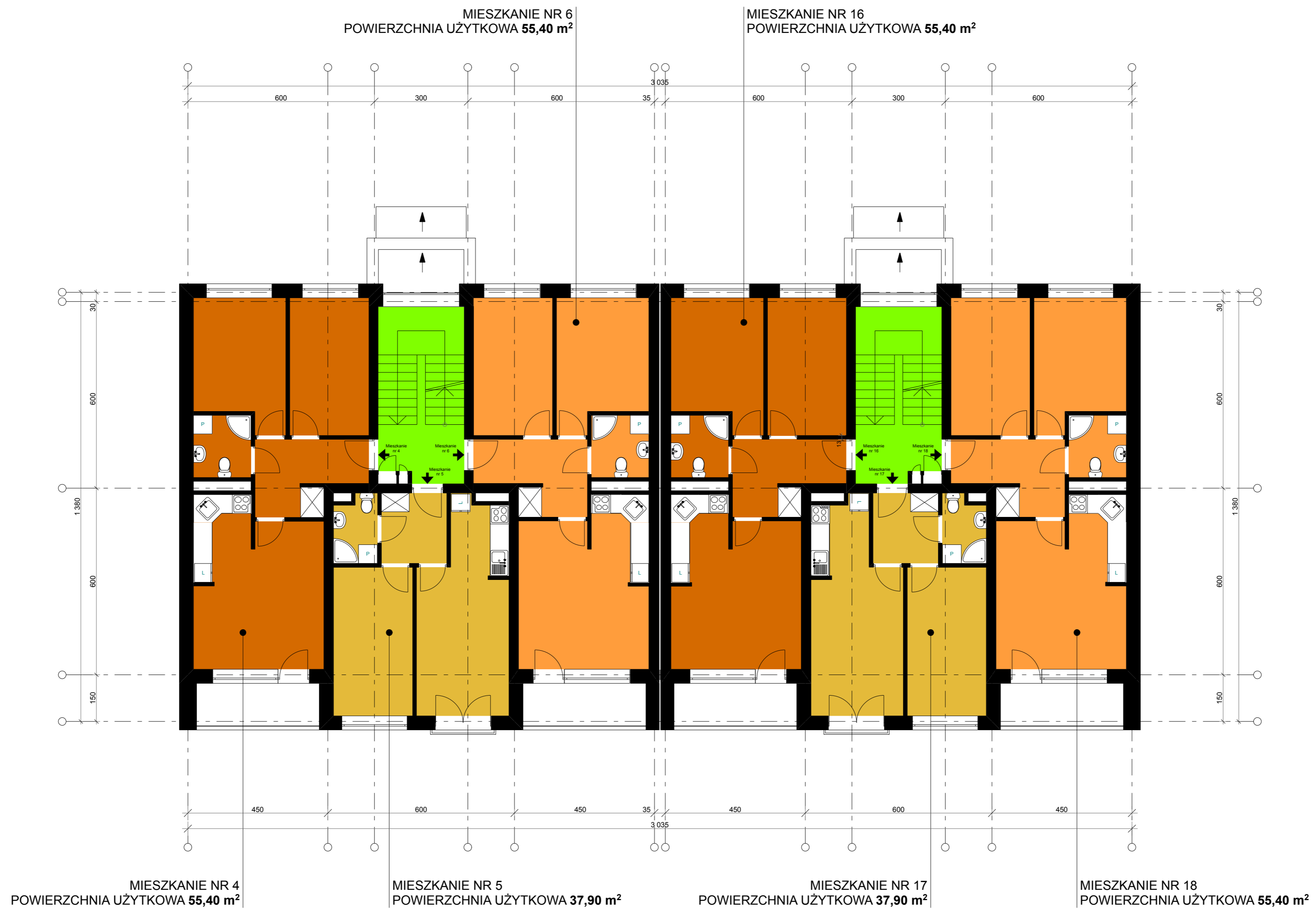
RZUT KONDYGNACJI POWTARZALNEJ SKALA 1:100
